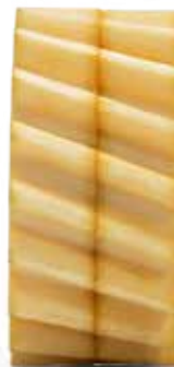
Смазочная шестерня для шестерен с правым подъемом винтовой линии (RH)
