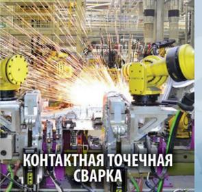
КОНТАКТНАЯ ТОЧЕЧНАЯ СВАРКА
